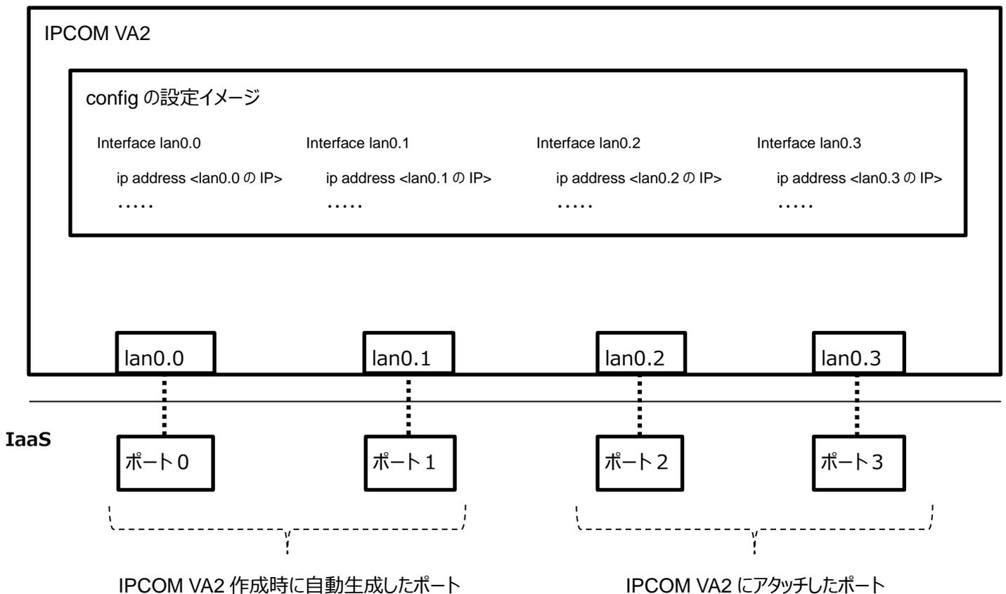
前述のインターフェースの認識順序の仕様に示した通り、本例では、ポート 0～ポート 3 がそれぞれ lan0.0～lan0.3 として IPCOM VA2 に認識されます。
