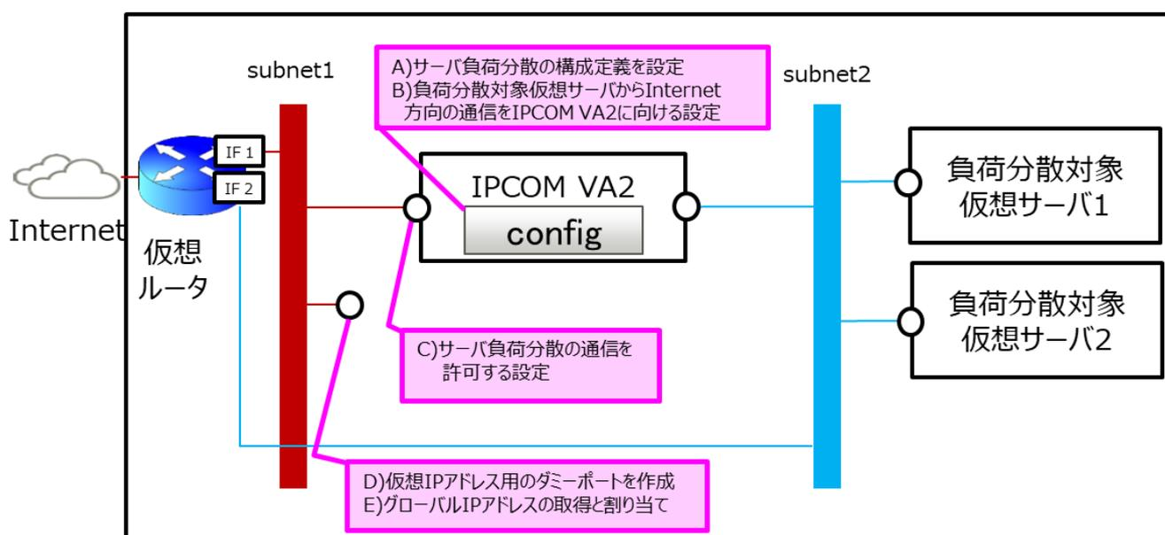
図 E-1-2 : IaaS 上のサーバ負荷分散機能使用時に必要な設定
