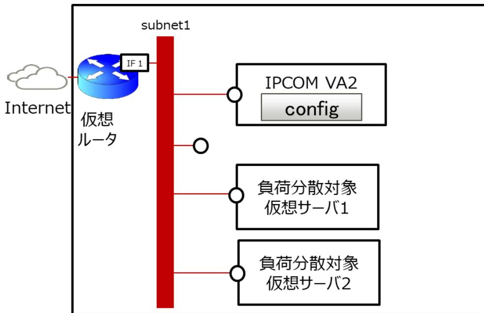
図 E-1-4 : IaaS 上の 1 つのサブネットに IPCOM VA2 と負荷分散対象仮想サーバを配置したワンアーム構成
